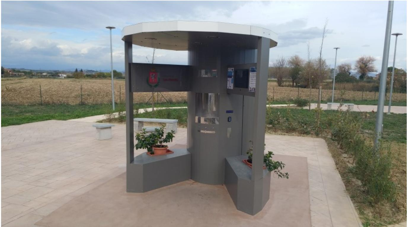
I fontanelli sono impianti realizzati per l'erogazione di acqua di alta qualità, alimentati con acqua dell'acquedotto filtrata per migliorarne le caratteristiche organolettiche. I fontanelli realizzati dal Comune sono dotati anche di un sistema di refrigerazione e gasatura dell'acqua.
